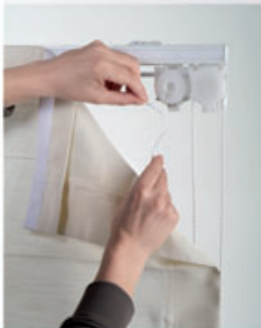
Aufzugsband von Gehäuse herausnehmen
